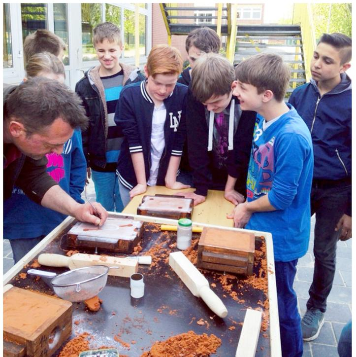
genaues Ausarbeiten von Gussformen und Gießkanälen
